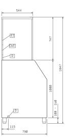
CWI1 = Attacco acqua fredda **D** = Scarico acqua EI = Connessione elettrica
